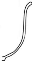
Выделите **Star**, примените к ней модификатор **Bevel Profile**, щелкните по кнопке **Pick Profile** и в любом видовом окне укажите на сплайн профиль чашки.
